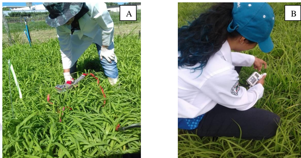
Figura 4 - Obten\u00e7\u00e3o de dados utilizando o IRGA (A) e o clorofil\u00f4metro port\u00e1til (B)
