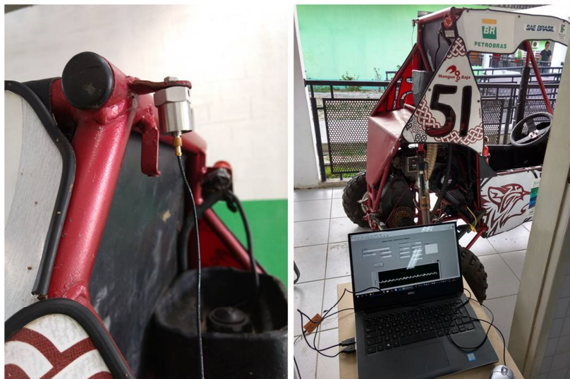
Figura 02: Montagem e medição com sensor de vibração estrutural.
