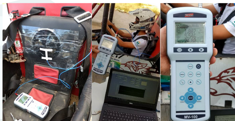
Figura 03: Montagem e medição com sensor de vibração ocupacional de corpo inteiro.
