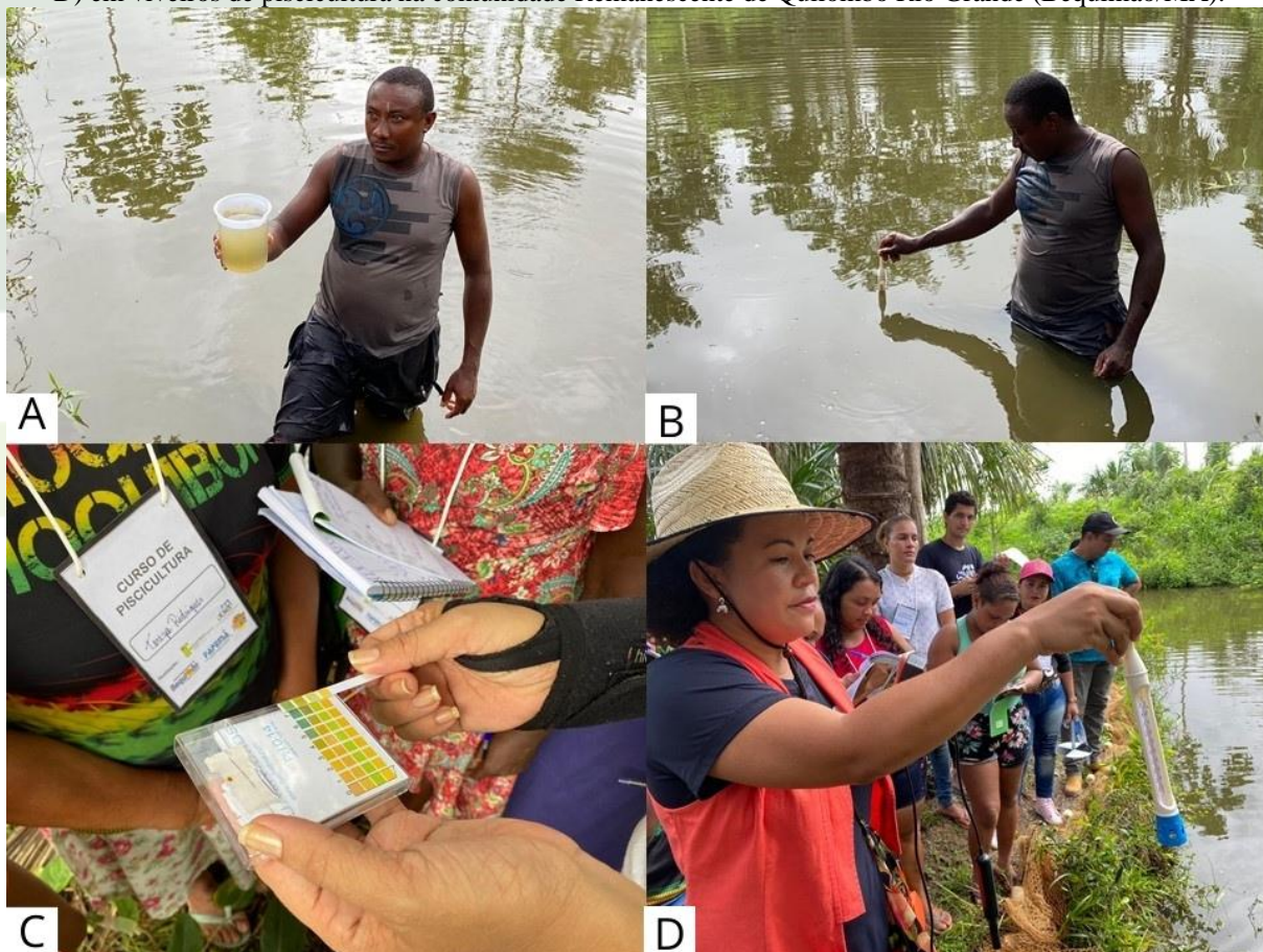
Figura 08. Avaliação dos parâmetros de qualidade de água: pH, oxigênio dissolvido (A; C) e temperatura (B; D) em viveiros de piscicultura na comunidade Remanescente de Quilombo Rio Grande (Bequimão/MA).
