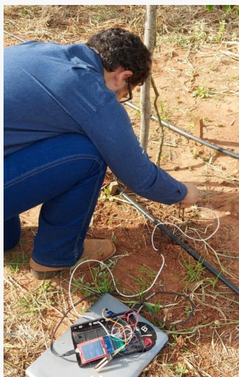
Figura 05. Mensuração da condutividade elétrica aparente do solo.
