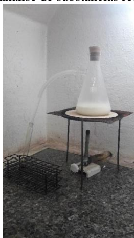
Figuras 2. Procedimento de análise de substâncias redutoras voláteis no leite UHT.
